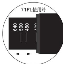
※ 1.4倍テレコンバーター-DGを使用する場合は、レンズの焦点距離に応じてチューブを前後させます。71FLの場合、f=400なので、左図のように400の位置へチューブを合わせます。
