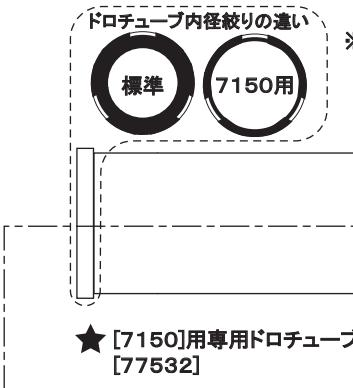
※ドロチューブ(黒い筒)は[7150]用専用ドロチューブ[77532]を使用してください。標準のドロチューブでは、内径でケラれます。
