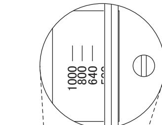
※基本的に500の目盛りが隠れるくらいに合わせてご使用下さい。チューブを固定しているネジはコインで回すことができます。径の合わないマイナスドライバーなどで締めると、ネジを傷めるがあります。また、強く締めすぎると像が歪むことがありますのでご注意下さい。
