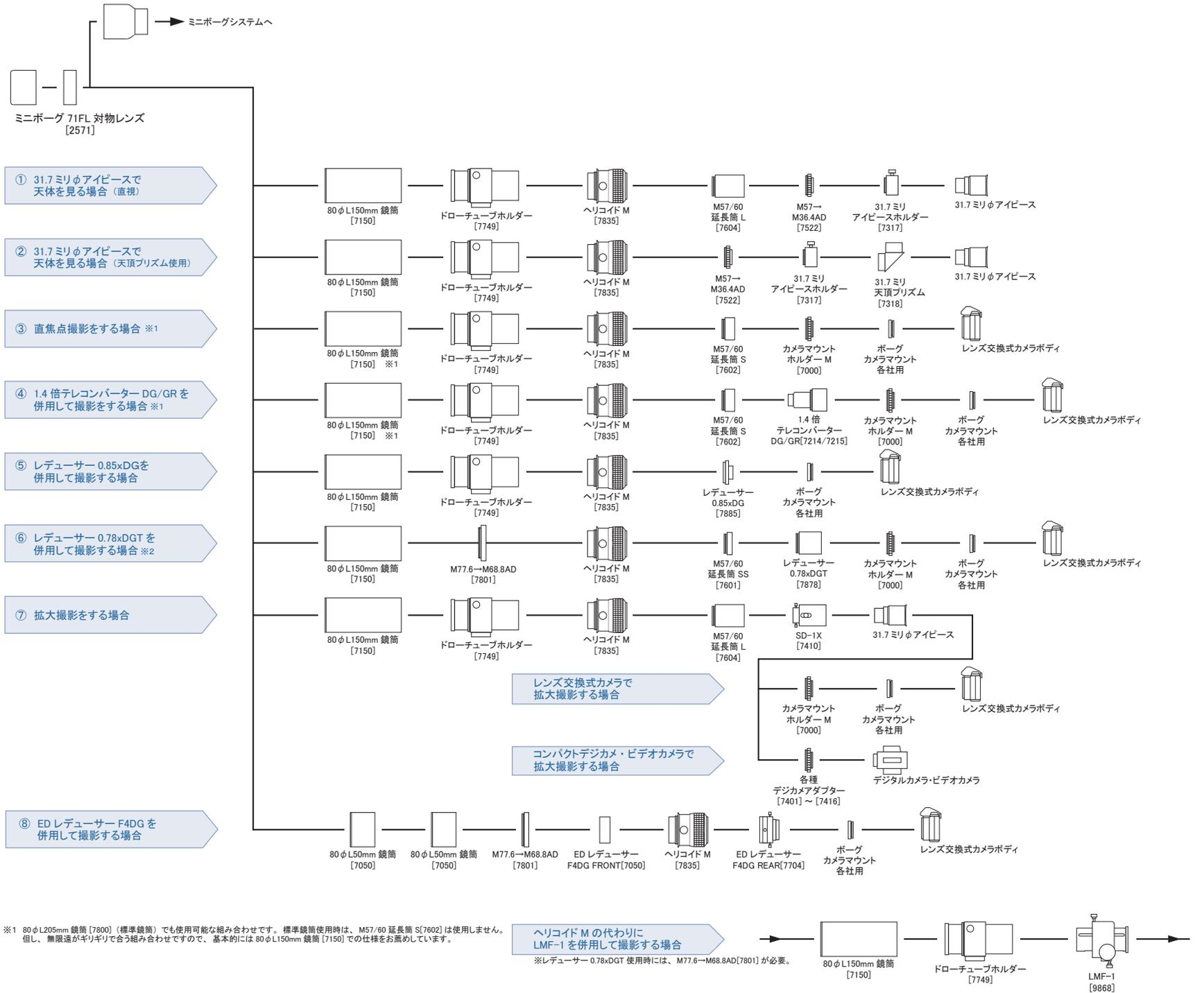
※1 80φL205mm 鏡筒 [7800] (標準鏡筒) でも使用可能な組み合わせです。標準鏡筒使用時は、M57/60 延長筒 S[7602] は使用しません。但し、無限遠がギリギリで合う組み合わせですので、基本的には80φL150mm 鏡筒 [7150] での仕様をお薦めしています。
